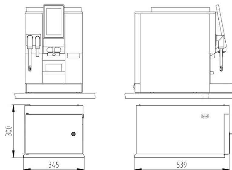
Unterstellkühlleinheit unter Kaffeemaschine
